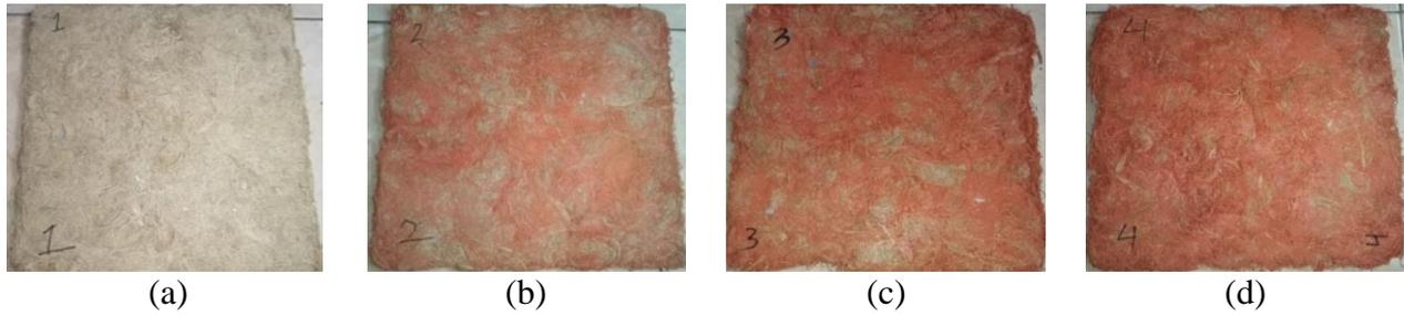
Gambar 4. Hasil pabrikasi papan komposit tampak atas dengan perbandingan komposisi *filler* serat kulit jagung dan timbal oksida berturut-turut; (a) 50:0, (b) 30:20, (c) 25:25, dan (d) 20:30
