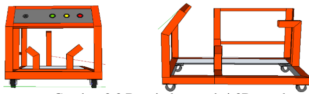
Gambar 3.3 Desain konstruksi 3D rangka engine stand tampak depan dan samping
