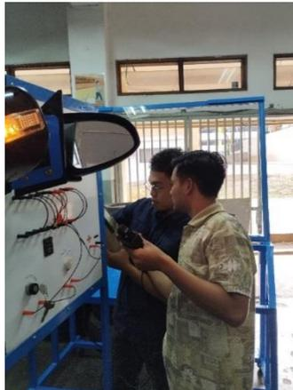
Gambar 2. Pemasangan *electric mirror*
