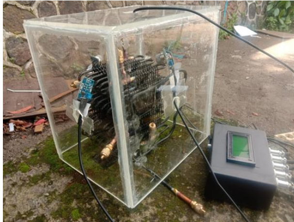
Gambar 5 Pengujian Sensor Alat pada Mini Kondenser
