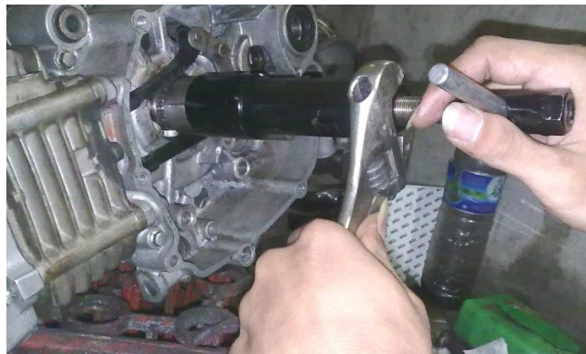
Gambar 1. Melepas timing gear dengan alat SST
