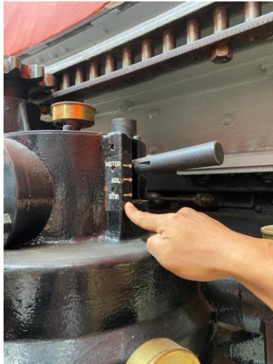
Gambar 2.5.5 Switch Control pada motor penggerak
