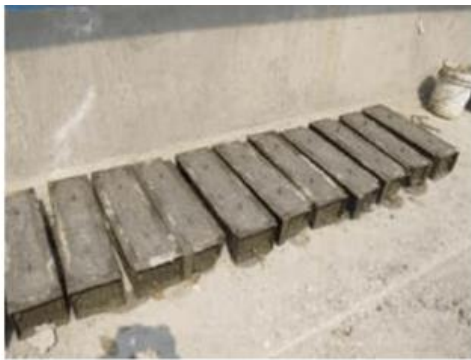
Gambar 9. Car Stopper dari Waste Material Beton
