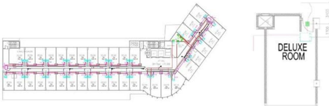
**Gambar 14.** Diagram Flow Penghawaan General (Kiri) dan Kamar (Kanan)
