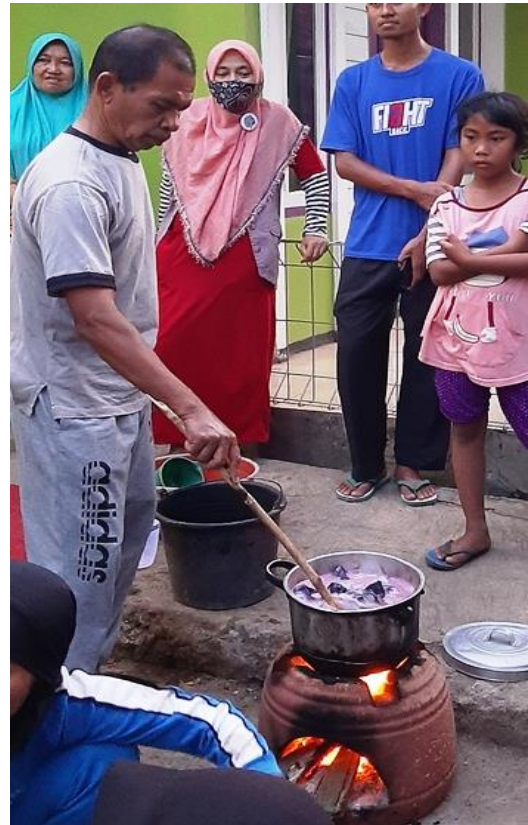
Foto 11. Pelorodan malam atau disebut mbabar atau ngebyok dilakukan dengan cara dicelupkan dengan air panas
