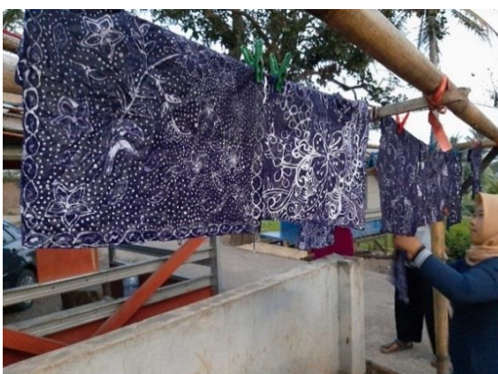
Foto10. Proses membangkitkan warna dengan cara pencelupan kain yang berisi larutan garam diazonium, kemudian ditiriskan hingga air yang menetes pada kain habis, tetapi jangan sampai diperas dan jangan sampai kering benar (kurang lebih 1-3 menit).
