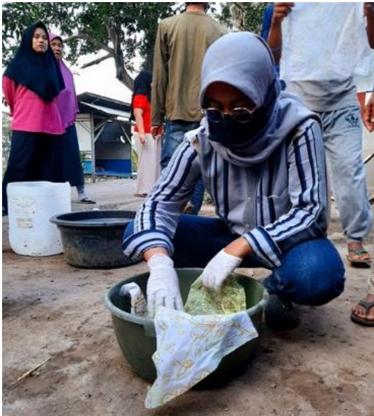
Foto 8 . Proses pelarutan zat warna naphthol AS sebagai warna dasar yang terdiri dari 3 bungkus plastik (naptol, TRO, kustik) ditaruh dalam diember.
