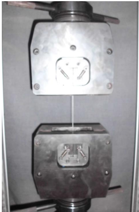
Gambar 11. Proses pengujian armor kabel fiber optik
