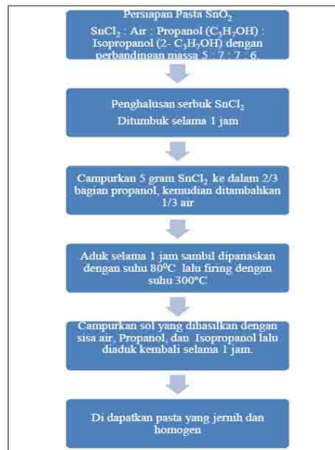
Gambar 7. Urutan Proses Pembentukan Pasta SnO 2
