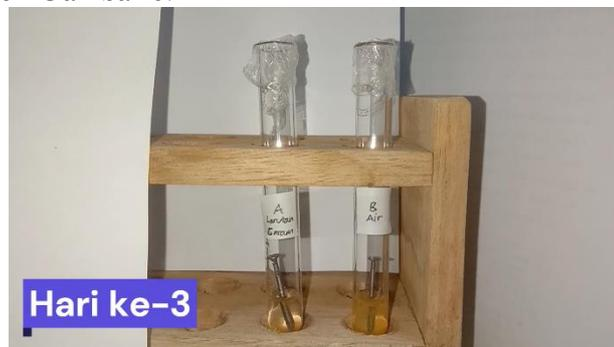
**Gambar 6.** Tangkapan layar video percobaan pengaruh adanya elektrolit terhadap korosi
