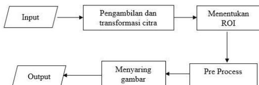
Gambar. 1 Desain Eksperimen sistem deteksi objek
