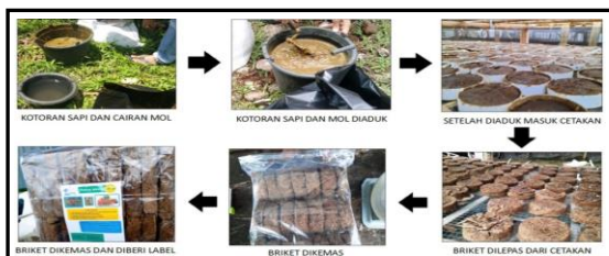
Gambar 2. Langkah-langkah membuat briket kotoran sapi
